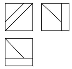
**Ejercicio segundo.** Se da el croquis de una figura técnica. Reproducir a escala 1:1 dejando constancia de las construcciones auxiliares, así como de los centros y puntos de tangencia.
